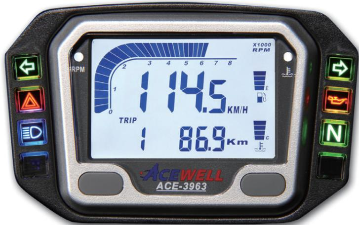
ACE-3800シリーズに水油温計機能が内蔵されたACE-3963。しかし、3963は単に温度計が内蔵されたマイナーチェンジではありません。LCDは表示される情報量がアップしても十分な視認性が得られる新デザイン、そして新設計のPCBはさらに処理能力をUP。最高速度は399.9Km/hに、タコメーターは10rpm刻みに進化しています。今まで機種選択の悩みだった燃料計の抵抗値も、100Ω、250Ω、510Ωの切替式になりました。設定で機能を止めればメーター上から燃料関係の表示は全てなくなり、シフトタイミングを知らせるシフトワーニング機能も大幅に進化、専用LEDを追加して緑⇒オレンジ⇒赤点滅へと変化して的確にライダーに知らせます。イルミネーションはホワイトLEDで夜でもくっきり。12Vバッテリー装着車専用(バッテリーレス車には使用できません。)サイズ125mm×78mm×28.5mm
