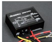
AC/DC50Vまでの耐圧でメーターを保護するレギュレーターレクチファイヤユニット。交流バッテリーレス車には必須のオプションです。高信頼のスイッチング電源回路を採用し、安定した12V、最大0.5Aを出力します。メーター以外に消費電流0.5A未満の12V系機器の保護にもご利用いただけます。SR5012-0.5
