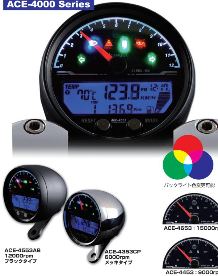
ACEWELL 初となるデジタル制御の針式タコメータを装備したハイグレードモデルです。さらに多くの機能をコンパクトなボディに凝縮しています。液晶ディスプレイには速度、バググラフ燃料計、水油温または気温、時計と、さらに他1機能の値を同時に表示することが可能です。バックライトには御希望の多かった変色機能を装備しました。バックライト色を変更できることを利用して、オーバーヒート時にはバックライトが赤色と緑色に交互点滅して警告します。温度は水油温 1 系統だけではなく外気温計を標準装備。凍結など路面状況の把握などに利用できます。ハンドルに設置したリモートスイッチで便利に操作が出来るワイヤードリモコンも標準装備されています。筐体は高級感あふれるCNC加工されたアルミケース。車両に合わせて表面仕上げはメッキタイプとブラックタイプの2種類をご用意しました。12Vバッテリー搭載車専用(バッテリーレス車には使用できません) サイズ:直径(最大)80mm、奥行(最長)68mm
